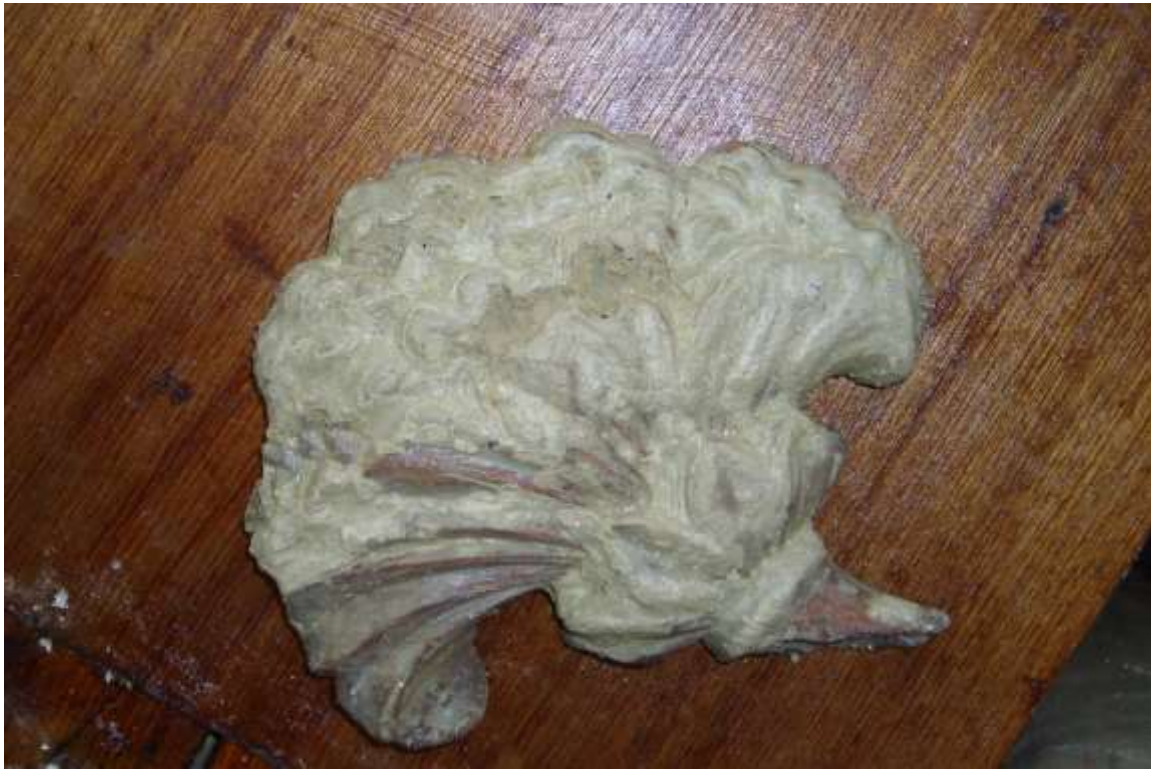
Abb. 50: Linke Blüte nach dem Entfernen der 7. Abbeizer-Schicht
