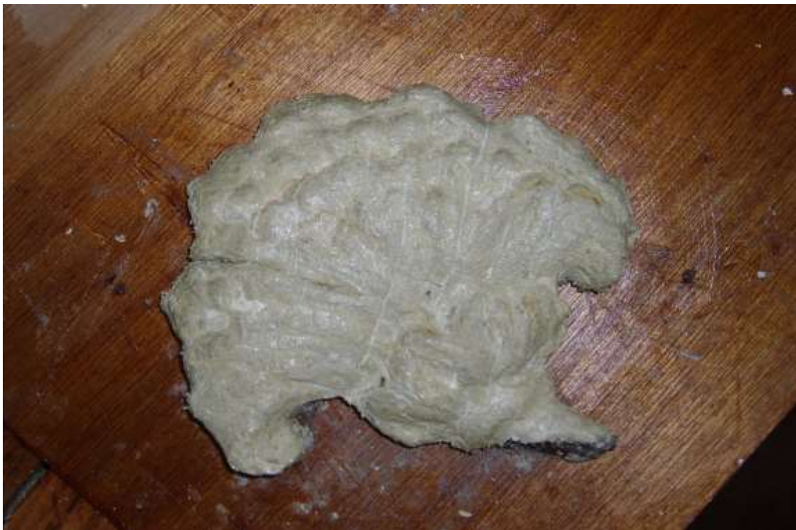
Abb. 47: Linke Blüte nach dem Entfernen der 4. Abbeizer-Schicht
